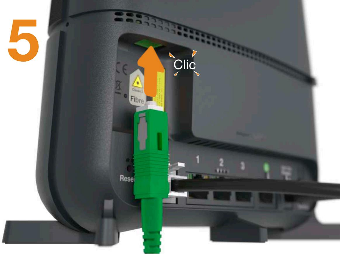
**Branchez** le câble optique à la prise « Fibre » verte de la Livebox.
